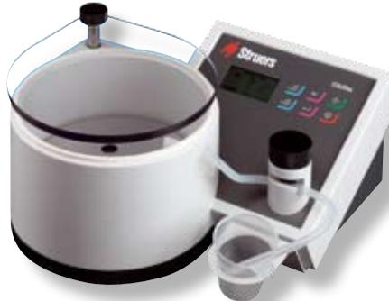
使用CitoVac将用树脂填充所有连接至表面的孔洞。这将加强脆性材料，并阻止在制备期间的Pull-outs和裂缝。
