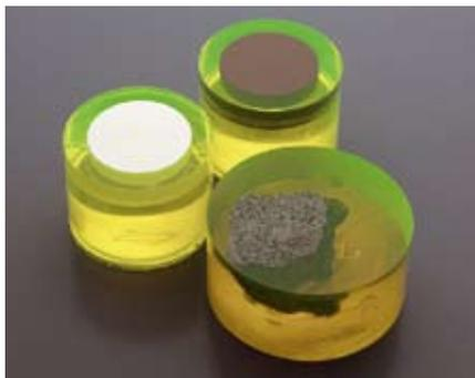
使用Struers荧光着色剂，可轻松识别孔洞和裂缝
