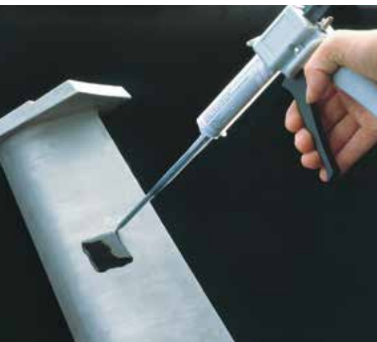
レプリセットを試料面に塗布
