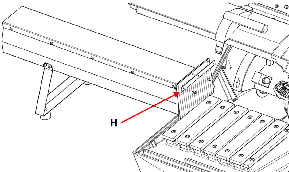
10. 通过转动支架 (I) 的支脚, 调整延长扩展台的角度, 直到其完全水平(使用水平仪)。
