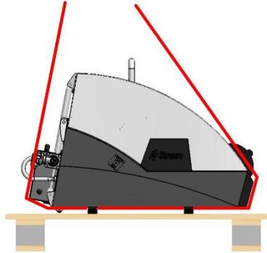
5. 将吊带放到机器左右两侧底座下方，使用起重机将 Labotom-5 提起。
