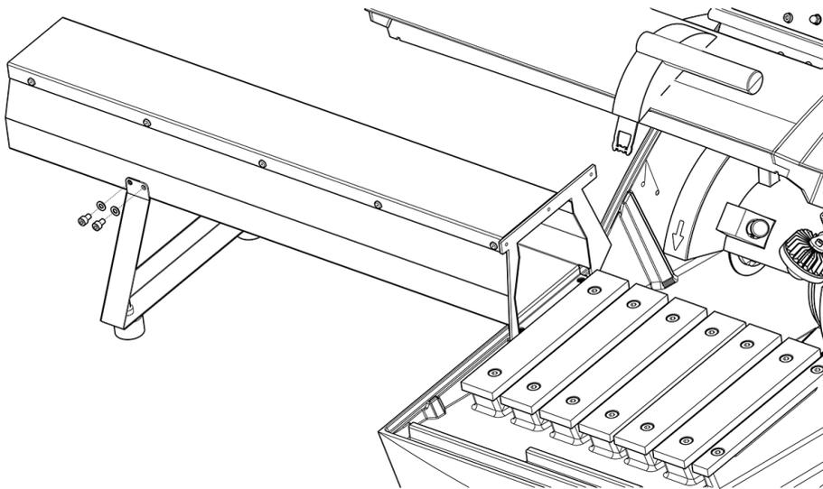
8. 使用 2 个 M8 螺钉 (G), 将延长扩展台安装在切割室的左侧。
