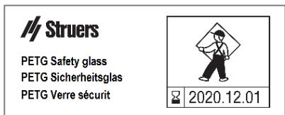
为确保其预期安全水平，PETG 防护板必须每 5 年更换一次<sup>3</sup>。防护罩上有标签标明应何时更换防护板。
