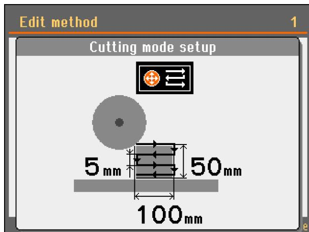
在 AxioCut 切割模式下, 垂直进给速度和水平进给速度相同。
