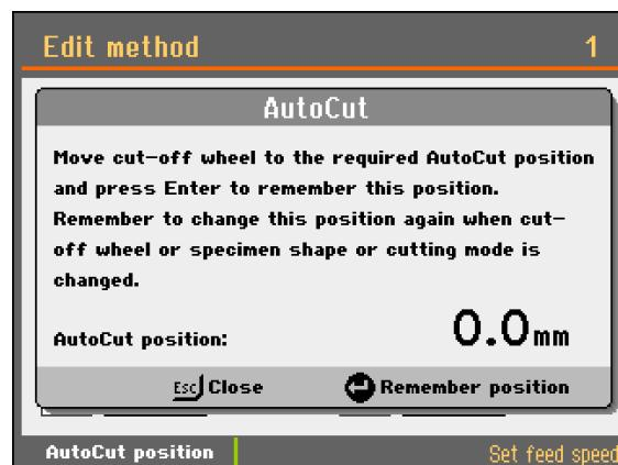
■ 使用操纵杆将切割轮移动到所需的自动切割开始位置。
