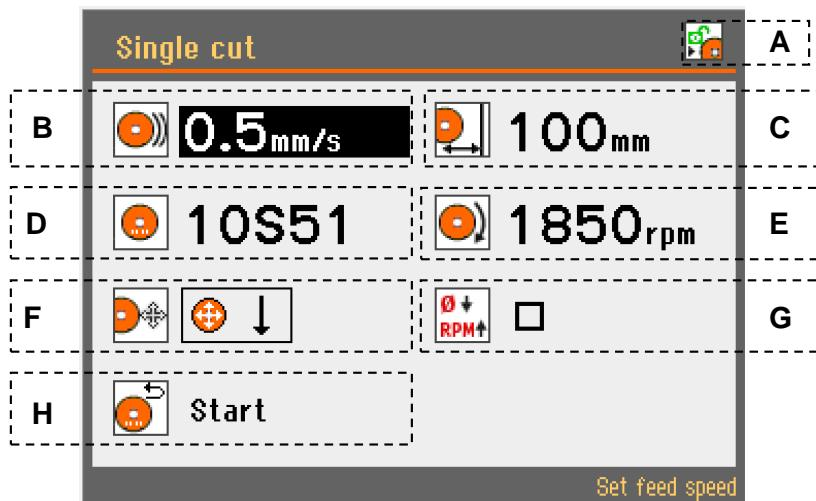
**A** 主轴锁状态**E** 切割轮转速**B** 进给速度**F** 切割模式**C** 切割长度**G** RPM 补偿\***D** 切割轮**H** 切割停止位置
