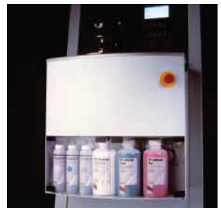
AbraPol-10 comprend une unité de dosage pour la suspension diamantée et les lubrifiants
