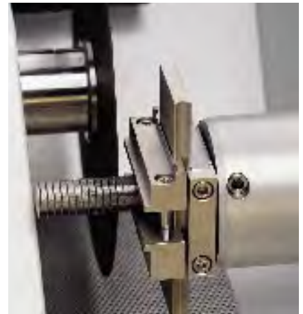
可以对Accutom-50进行编程，使其自动对同一试样连续进行薄片切割。
