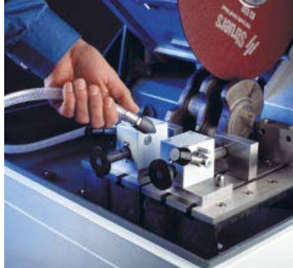
Eingebauter Spülschlauch mit verstellbarer Düse zur günstiger Reinigung
