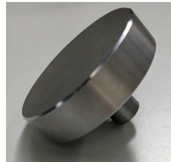
Enclume plate pour les échantillons de forme régulière.
