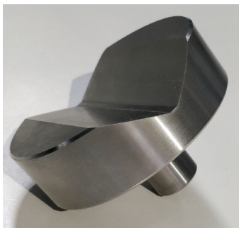
Enclume de type V pour les échantillons cylindriques (option).
