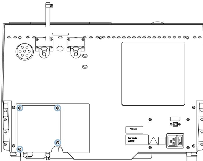
1. Rimuovere le quattro viti della placca di protezione sul retro della macchina.
